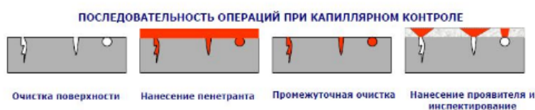
Рисунок 1. Процесс обнаружения дефектов капиллярным методом
